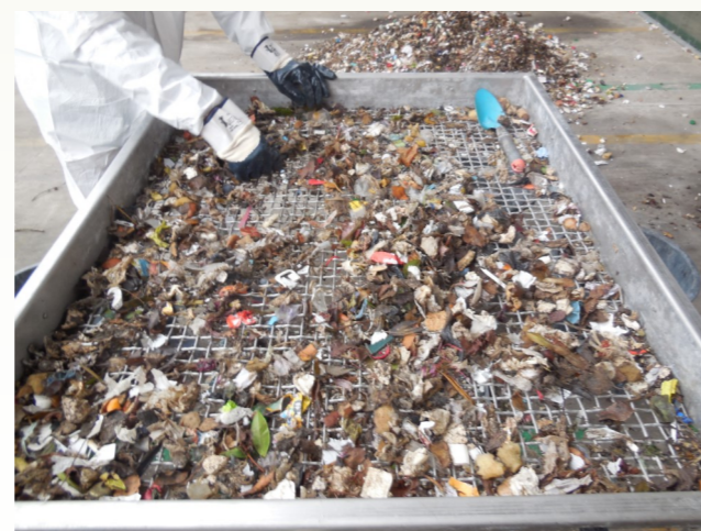
Vaglio utilizzato per le analisi merceologiche
